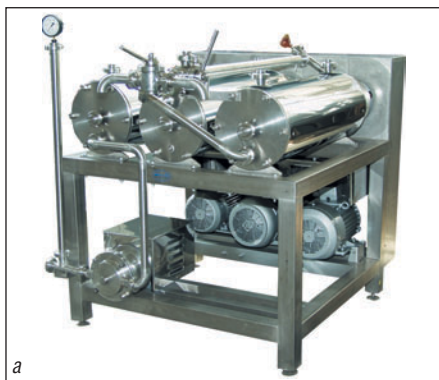
Рис. 2 Маслообразователи ТВФ4 производительностью, кг/ч: а – 0 б – 0 в – 0
