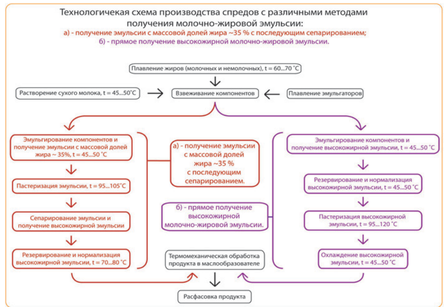
Рис. 2 Технологическая схема производства спредов различными методами получения молочно-жировой эмульсии
