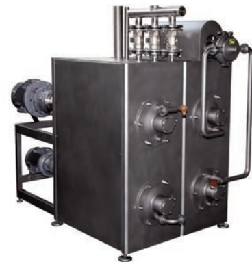
Рис. 3. Маслообразователь-вотатор ЮФТ-2.04 производительностью 1000–1200 кг/ч для производства сливочного масла и спредов
