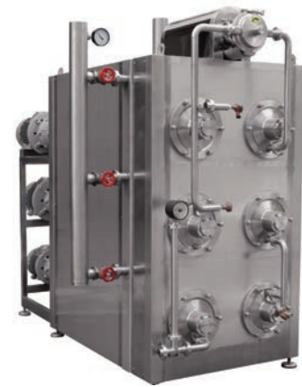
Рис. 2. Маслообразователь-вотатор ЮФТ-2.12 производительностью 3000–3500 кг/ч для производства сливочного масла и спредов
